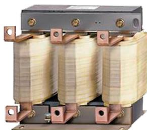
El conjunto reactor-capacitor conectados en serie debe ser utilizado para compensar la energía reactiva en las instalaciones eléctricas con contenido armónico, en este caso estos conjuntos compensan de energía reactiva a la frecuencia fundamental y evitan el paso de corrientes armónicas a través del capacitor, esto forma un filtro de rechazo y evita resonancias locales.
